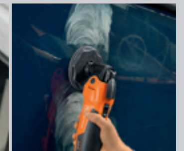
Verwijder krassen uit autolak met het vilten polijstpad en polijstmiddel.
