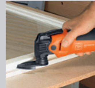
Schuurvingers voor gebruik in smalle ruimtes.
