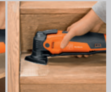
Slijpen bij hoeken en randen zonder teruglageffecten.
